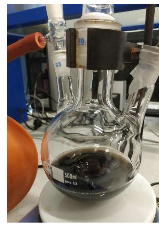
Rysunek 6. Synteza MIONs metodą współstrącania
