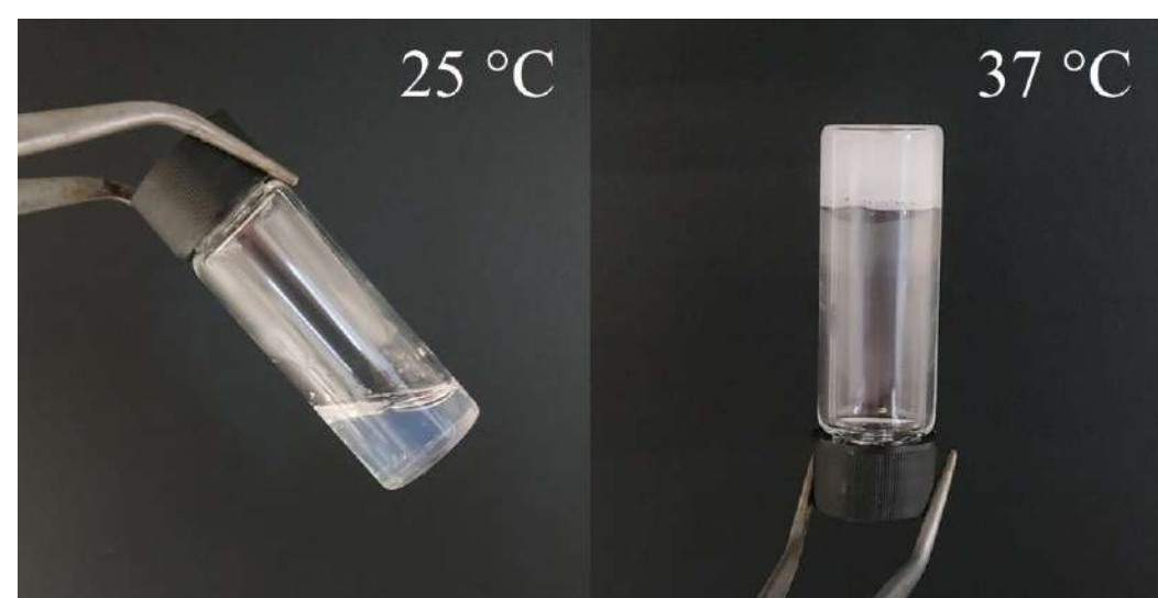
Rysunek 4. Przejście fazowe żel-żel termowrażliwego hydrożelu opartego na PCLA
